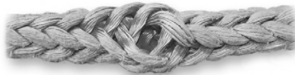
Comprimiendo el Cable a lo Largo
